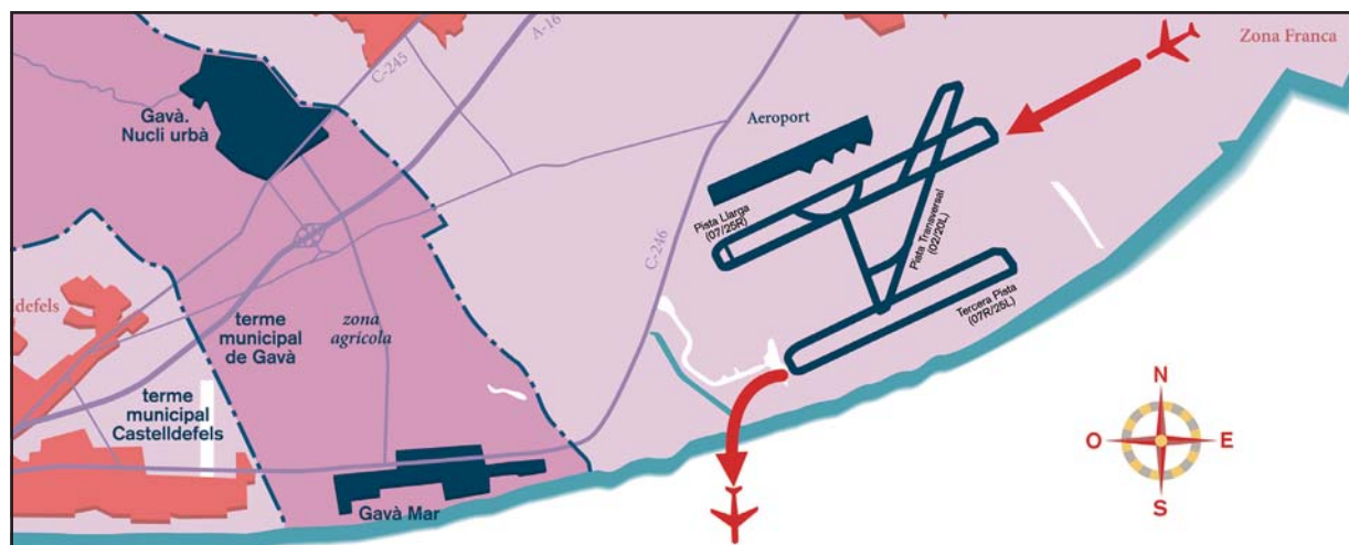
Configuració oest preferent: Enlairaments per la tercera pista (07R/25L) amb viratge immediat al mar de 60 graus. Aterratges per la pista llarga (07L/25R) perquè els avions sobrevolin el mar i la Zona Franca
