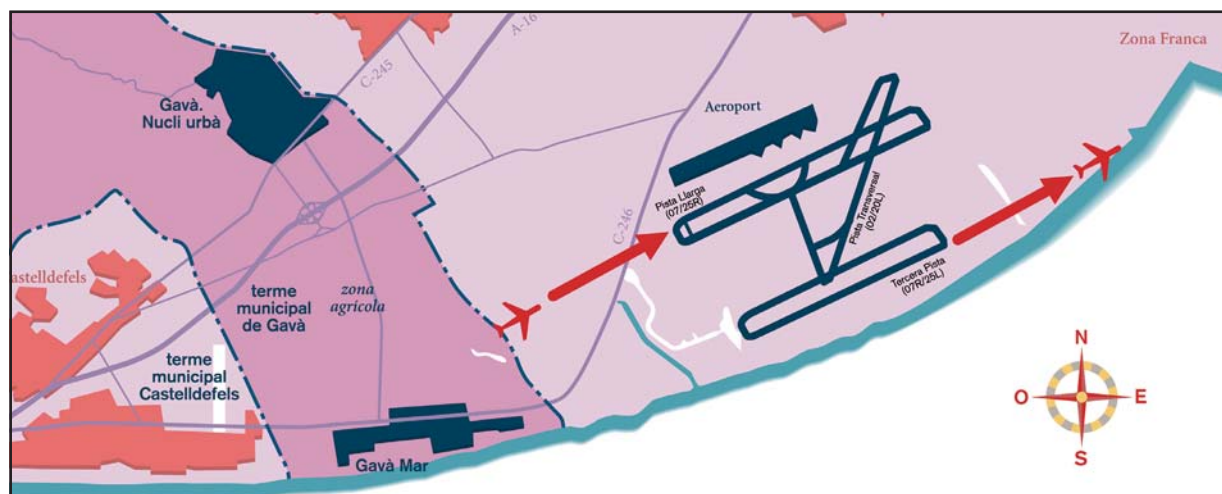
Configuració oest preferent: Enlairaments per la tercera pista (07R/25L) amb viratge immediat al mar de 60 graus. Aterratges per la pista llarga (07L/25R) perquè els avions sobrevolin el mar i la Zona Franca
