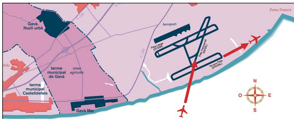
Configuració nocturna: enlairaments per la tercera pista (07R/25L) cap a la Zona Franca. Aterratges per la pista transversal (02/20) entrant pel mar per evitar l'impacte acústic sobre Gavà, Castelldefels i el Prat.
